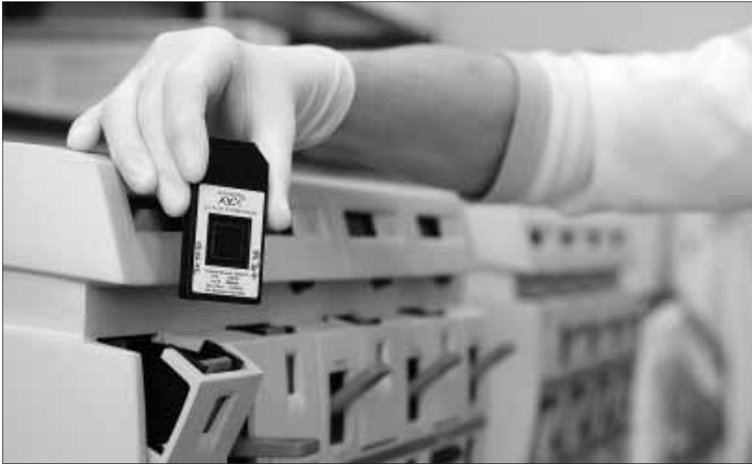
Drei solcher Chips genügen, um die 30 000 Gene eines Organismus zu erfassen. Ein mit einer Probe beladener Gen-Chip wird gescannt, um das Muster der Genaktivierung im Gewebe sichtbar zu machen. Normale und kranke Gewebe lassen sich so auf Genveränderungen hin vergleichen. (Bild Christoph Schumacher)
